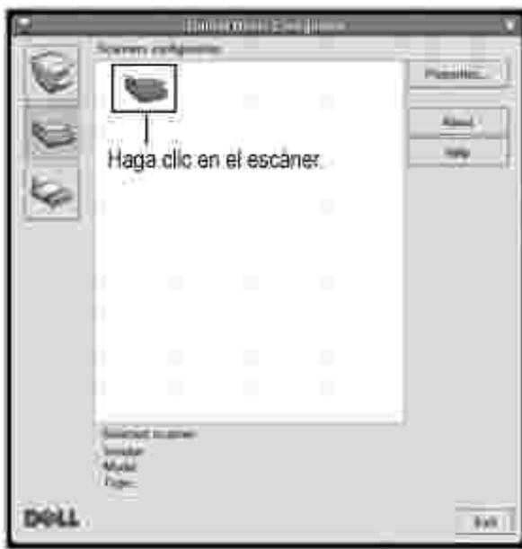
Cuando tiene un solo dispositivo MFP conectado al ordenador y encendido, el escáner aparece en la lista y se selecciona automáticamente.
