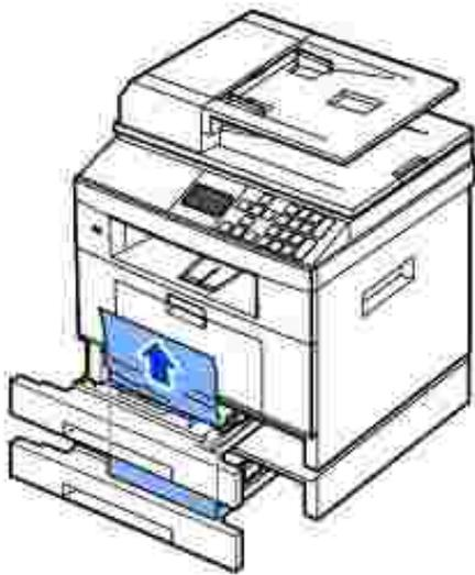
5. Coloque de nuevo las bandejas en la impresora.
