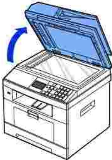
2. Coloque el documento *con la cara de impresión hacia abajo* en el cristal de exposición y alinéelo con la guía de registro situada en la esquina superior izquierda del cristal.
