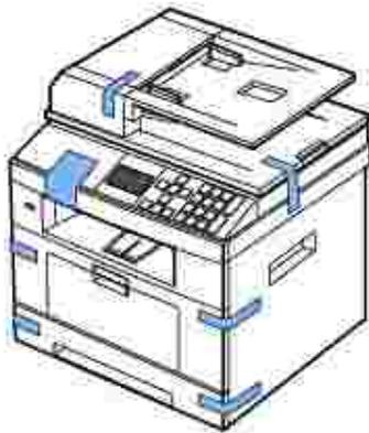
5. Despegue por completo la etiqueta del módulo del escáner tirando de ella con suavidad. El interruptor de desbloqueo del escáner debe moverse hacia adelante a la posición de desbloqueo al quitarse la etiqueta.
