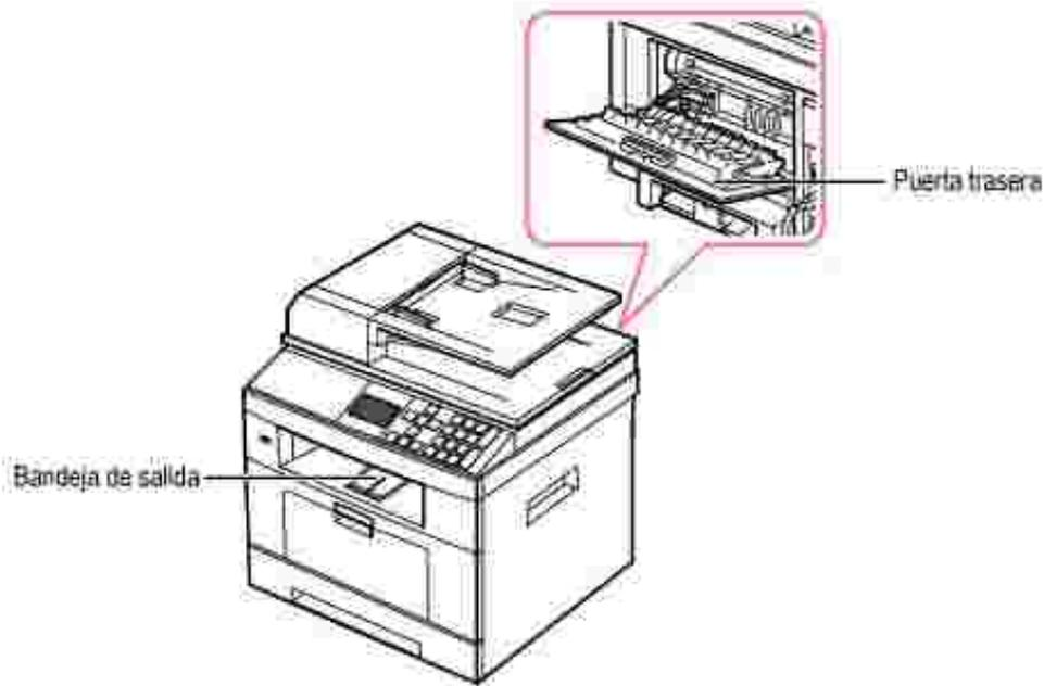
Si desea utilizar la bandeja de salida, asegúrese de que la puerta trasera esté cerrada. Si desea utilizar la puerta trasera, ábrala.
